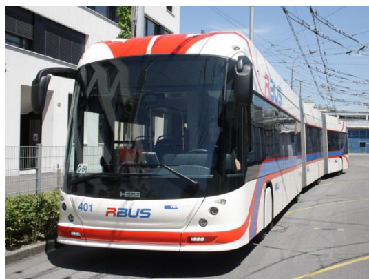
Doppelgelenktrolley RBUS mit eingehausten Rädern
