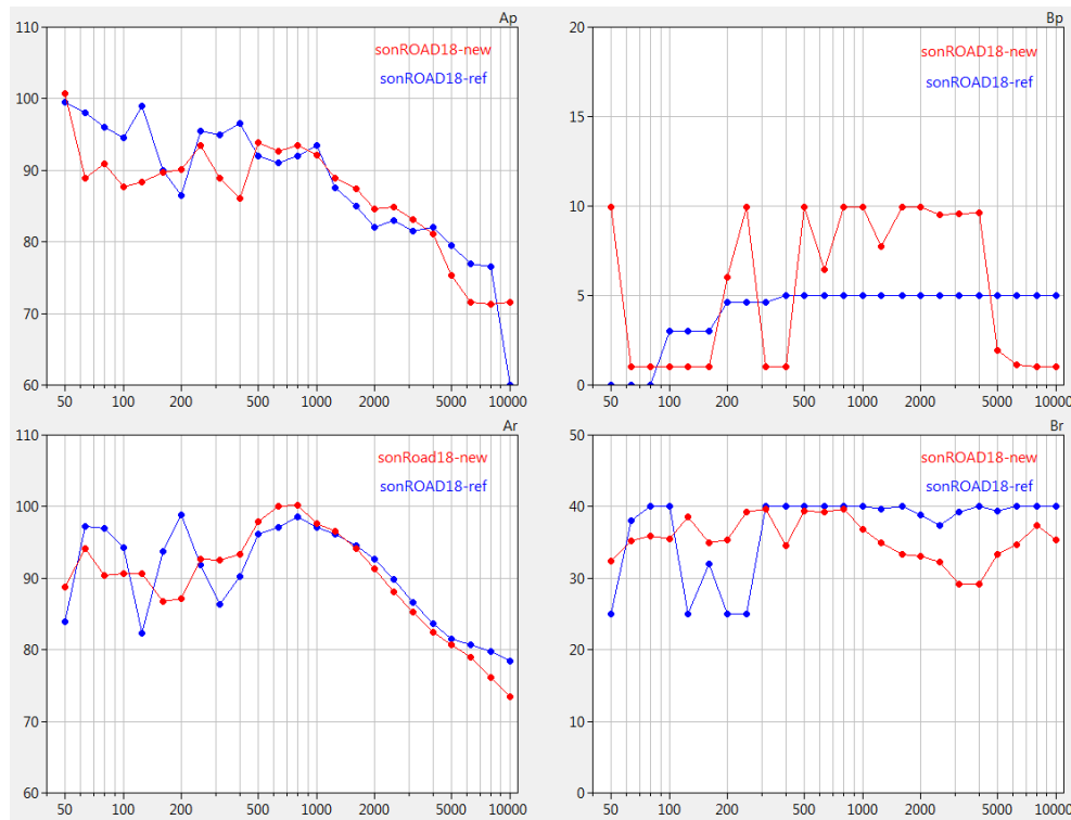
Abbildung 56: Spektrale Modellparameter in rot im Vergleich zu den Standardwerten SWISS10 cat 1 (blau).
